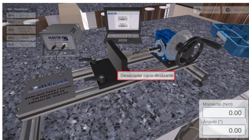
Observe que ao folgar o carro deslizante, o corpo de prova é removido e posicionado na mesa.
