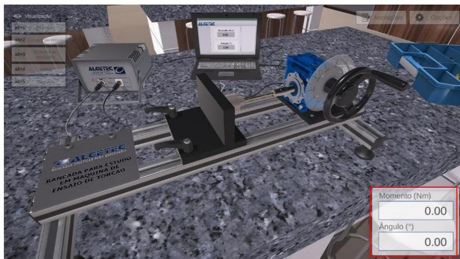
Aplique o torque no corpo de prova, realizando o giro no volante da máquina de ensaio de tração.
