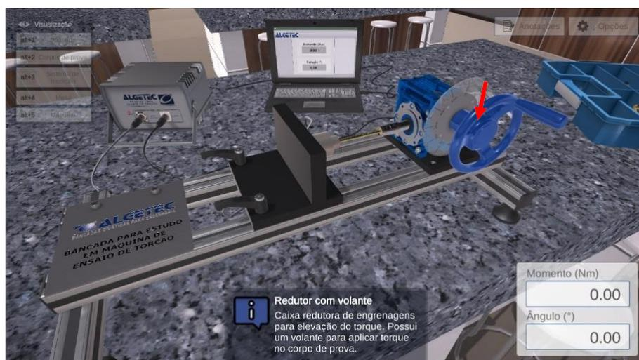
**Atenção:** Gire o volante da caixa redutora até que o corpo de prova atinja a ruptura.
